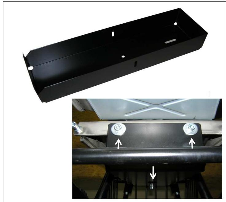
Bild 12: Keilriemenschutz, nur 3 Schrauben lösen
